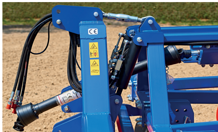
hydraulisch verstellbare Tiefenlockerung
