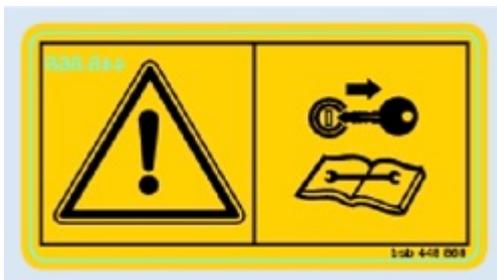
Vor Wartungs- und Reparaturarbeiten den Motor abstellen und Schlüssel abziehen.
