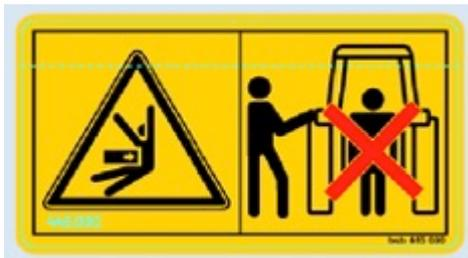
Bei Betätigung des Krafthebers außerhalb des Hubbereichs der Dreipunktaufhängung bleiben.
