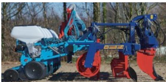
Die Häufelkörper sollten ca. zur Hälfte mit Boden bei der Fahrt gefüllt sein und durch die Arbeitsgeschwindigkeit von ca. 7 bis 9 km/h optimal arbeiten.
